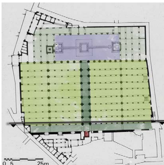
Εικ.17: Φεζ. Το τέμενος al Qarawiyyin: Διακρίνουμε τρεις φάσεις κατασκευής. Παρατηρούμε ότι οι φάσεις είναι ευδιάκριτες τόσο στο εξωτερικό του τεμένους, με την ανισοσταθμία της στέγασης, όσο και στην κάτοψη, με τα εγκάρσια τόξα και τις ισχυρές στηρίξεις τους να υποδηλώνουν τα όρια των παλαιότερων φάσεων. [Φωτογραφία: http://www.skyscrapercity.com . Κάτοψη: http://www.archnet.org , Keith Turner, MIT Libraries, Aga Khan Documentation Center]
