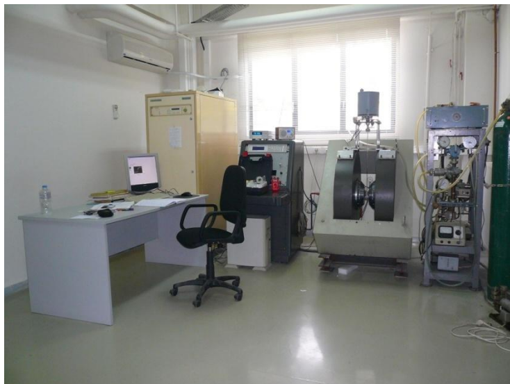
Εικόνα 19. Μαγνητόμετρο δονούμενου δείγματος Ινστιτούτου Επιστήμης Υλικών του ΕΚΕΦΕ "Δημόκριτος"
