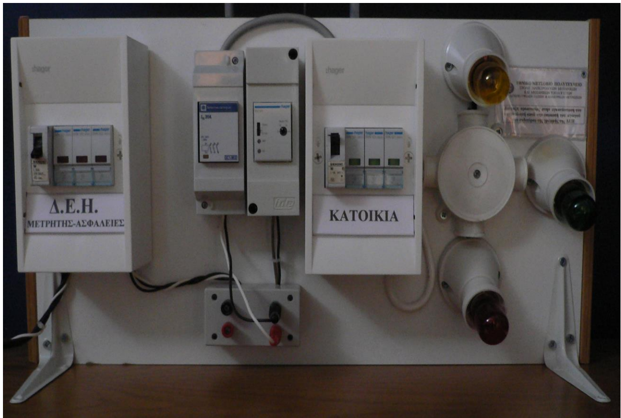
Σχήμα 5.3-2: Πειραματική διάταξη προστασίας μέσω επιτηρητή τάσης
