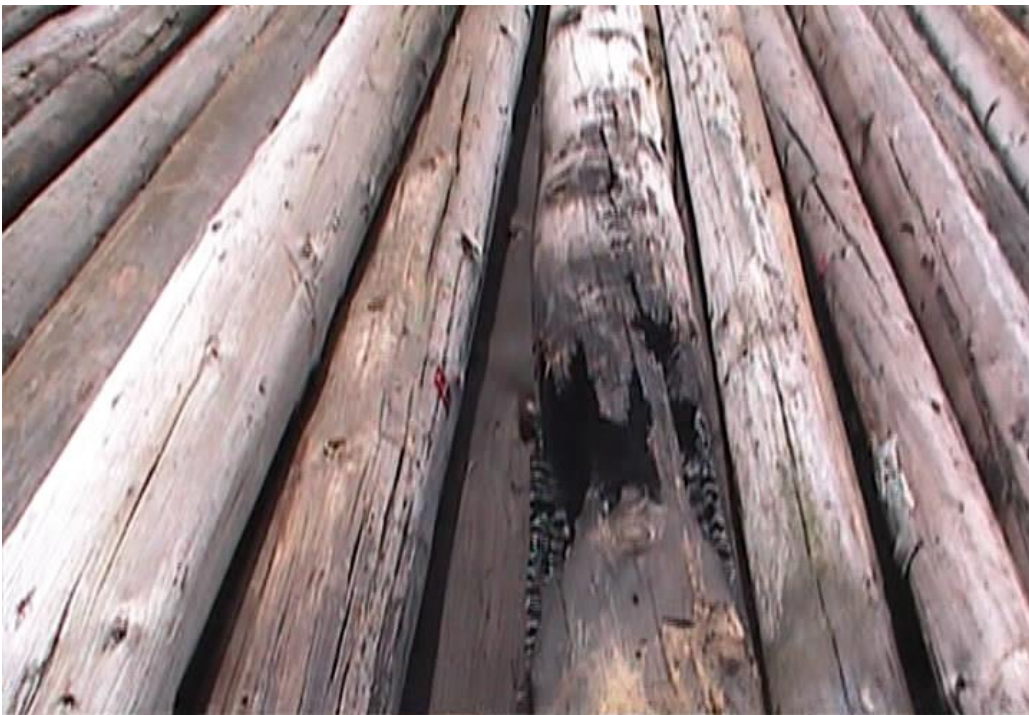
Φωτογραφία 6: διάδοση φλόγας στο εγκάρσιο του στύλου
