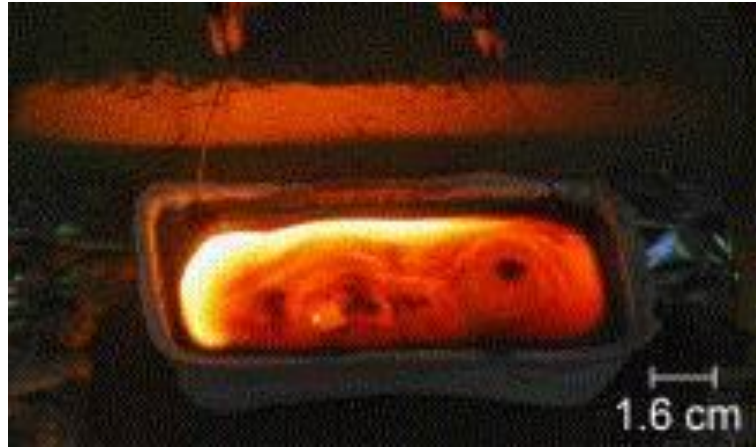
Εικόνα 11. Προϊόν SHS αντίδρασης σε καλούπι
