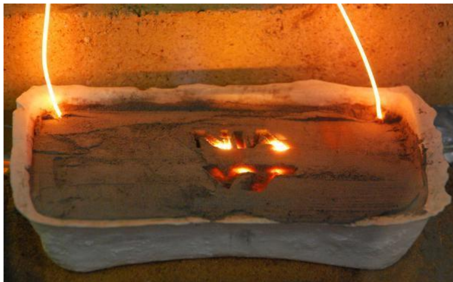
Εικόνα 10. Αντίδραση SHS μέσα σε καλούπι
