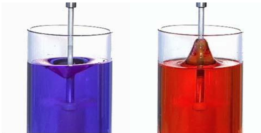
Εικόνα 10: Αριστερά: Νευτωνικό Ρευστό - Φυγόκεντρη δύναμη. Δεξιά: Πολυμερικό διάλυμα/Τήγμα - Εντροπική ελαστικότητα αλυσίδων που οδηγεί σε κάθετες δυνάμεις (22)
