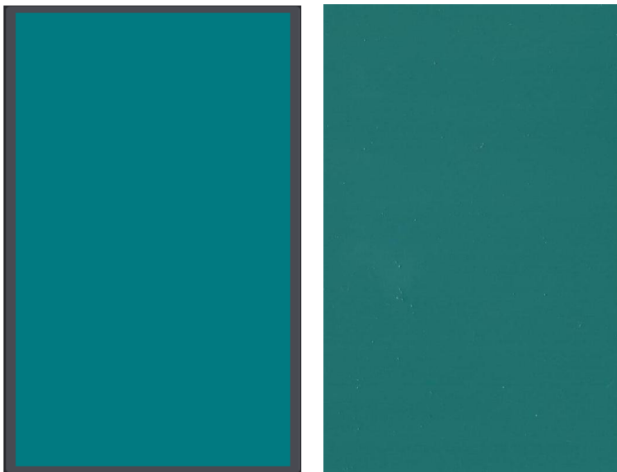
Εικόνα 17: Αριστερά: Πρότυπη απόχρωση RAL 5021 5 Water Blue (30) Δεξιά: Παραγόμενο αλκυδικό χρώμα απόχρωσης RAL 5021
