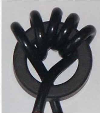
Σχήμα 3.15: Balun για την μείωση του θορύβου
