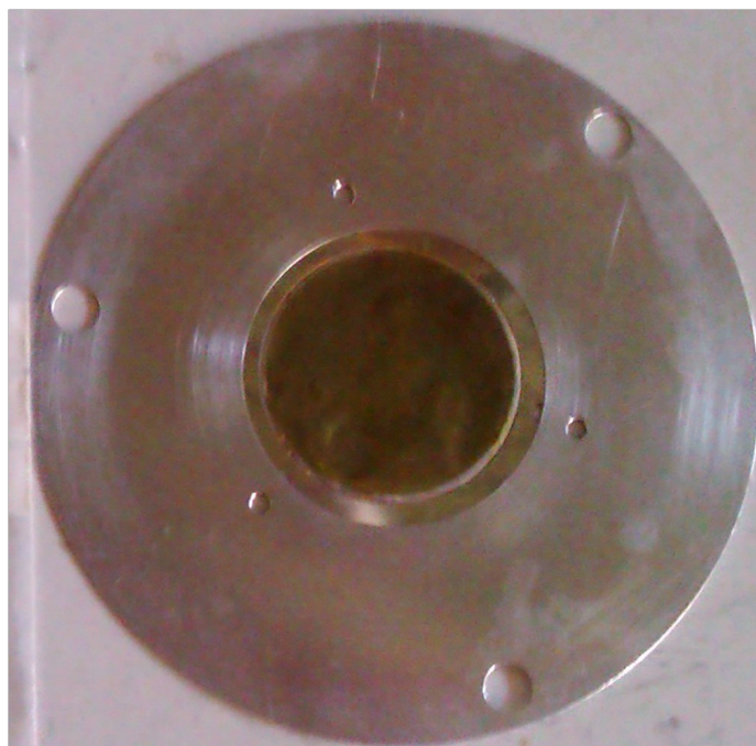
Σχήμα 4.1: Ο στόχος ^{238}\text{U} τοποθετημένος στο ηλεκτρόδιο ολίσθησης πριν την τοποθέτηση της μάσκας
