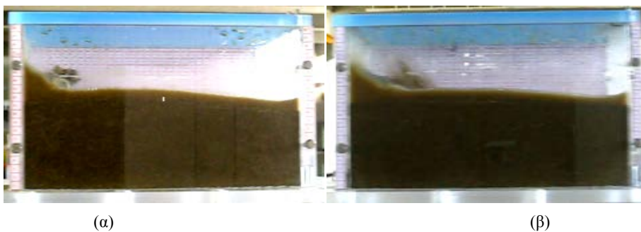
Εικόνα 43. Σύγκριση πειραμάτων με/χωρίς αρχικές συνθήκες στην κίνηση sway, με ποσοστό σε υγρασία 35%. (α) Πείραμα με αρχικές συνθήκες για f=1.2\text{Hz} , A=8.2\text{cm} . (β) Πείραμα με μηδενικές αρχικές συνθήκες για f=1.2\text{Hz} , A=8.2\text{cm} .
