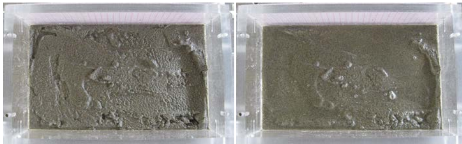
Εικόνα 27. Κίνηση sway για την άμμο με ποσοστό σε υγρασία 27.5% και διέγερση 5min. Η επιφάνεια της άμμου πριν (α) και μετά (β) τη διέγερσης σε συχνότητα 0.6Hz και πλάτος 0.2cm.
