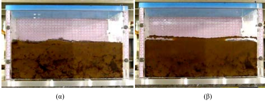
Εικόνα 47. Διαμόρφωση των κηλίδων υγρασίας στο δείγμα του υγρού ελαιοπυρήνα, πριν (α) και μετά (β) τη διέγερση της δεξαμενής στην κίνηση roll.
