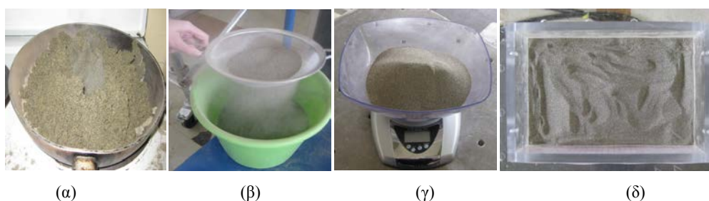
Εικόνα 17. Προετοιμασία πειραμάτων. (α) Ψήσιμο της άμμου. (β) Κοσκίνισμα. (γ) Ζύγισμα. (δ) Γέμισμα της δεξαμενής
