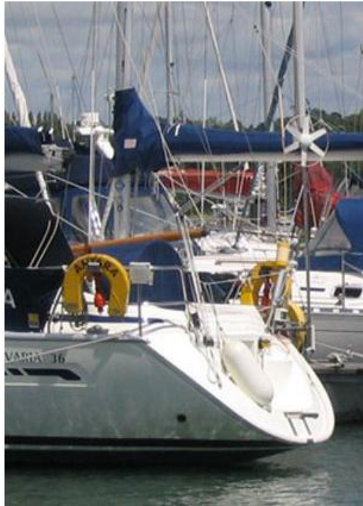
Εικόνα 4-20 : Παράδειγμα εγκατάστασης ανεμογεννήτριας σε ιστιοπλοϊκό σκάφος
