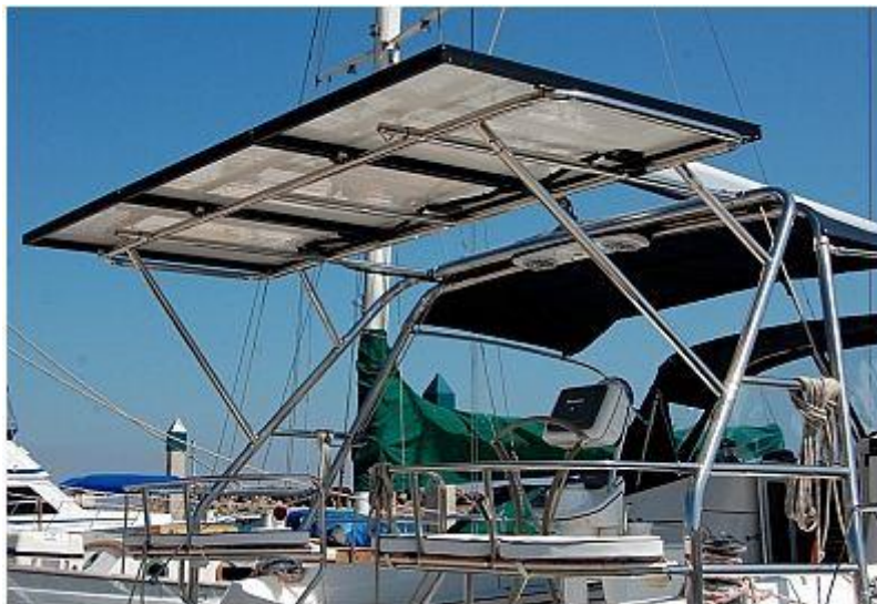
Εικόνα 4-19 : Αλουμινένιος σκελετός στήριξης φωτοβολταϊκών πλαισίων
