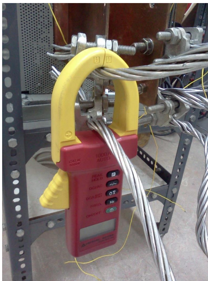
Σχήμα 3-11: Αμπεροτσιμπίδα που χρησιμοποιήθηκε στις μετρήσεις
