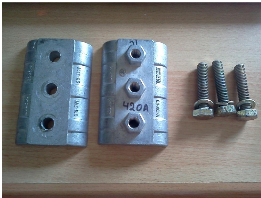
Σχήμα 3-4: Σύνδεσμος RIVIMENTAL GR261-A, ACSR-95, AAAC-185 που μετρήθηκε
