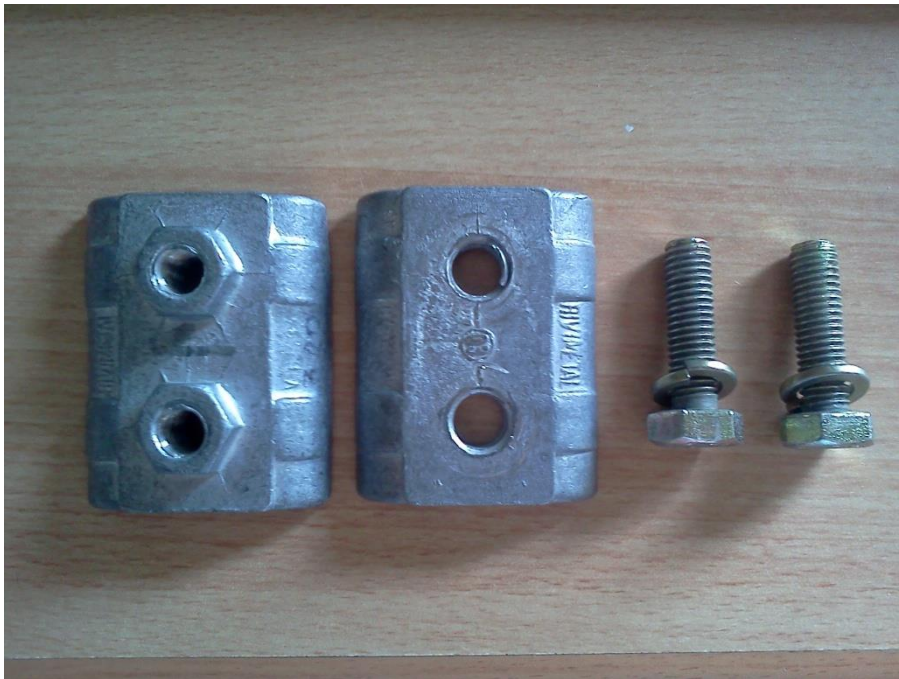
Σχήμα 3-2: Σύνδεσμος RIVIMETAL AI 50-70 GR-261-A που μετρήθηκε
