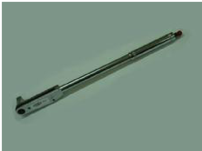
Σχήμα 3-12: Ροπόκλειδο για τη ρύθμιση της ροπής σύσφιξης
