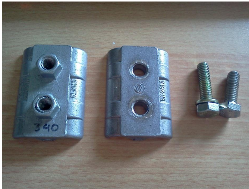
Σχήμα 3-3: Σύνδεσμος RIVIMETAL, AAAC 70 - ACSR 35, GR-261-A που μετρήθηκε
