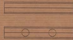
2 σωλήνες stabi 37, μήκους 60mm Φ10mm (πάχος σωλήνα 1mm), ο ένας με 2 τρύπες Φ6.5mm σε απόσταση 15 mm από τα άκρα
