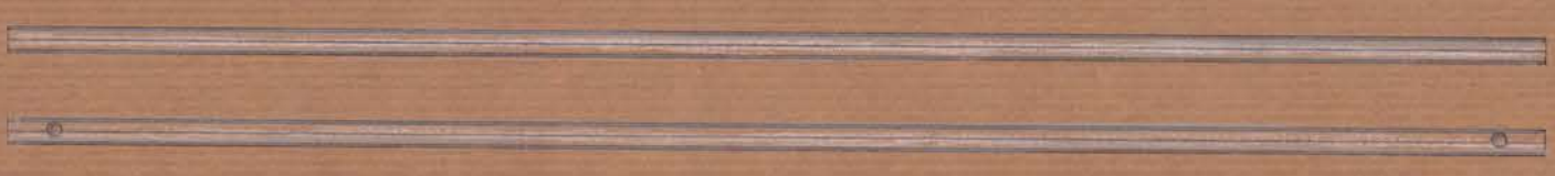
2 σωλήνες stabi 37 μήκους 600mm Φ10mm (πάχος σωλήνα 1mm), ο ένας με 2 τρύπες Φ6.5mm σε απόσταση 15 mm από τα άκρα
