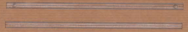
2 σωλήνες stabi 37 μήκους 300mm Φ10mm (πάχος σωλήνα 1mm), ο ένας με 2 τρύπες Φ6.5mm σε απόσταση 15mm από τα άκρα
