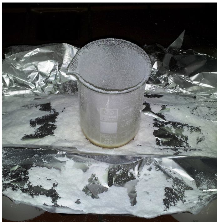
Σχήμα III.3. Τελικό προϊόν της ένωσης \text{La}_{9.33}\text{Si}_6\text{O}_{26+\delta} , όπως αυτό προέκυψε ύστερα από την αντίδραση καύσης γλυκίνης και νιτρικών αλάτων.
