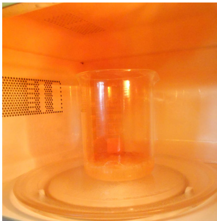
Σχήμα III.1. Φαινόμενο παρατήρησης πορτοκαλί ατμών κατά την διάρκεια της σύνθεσης Pechini.
