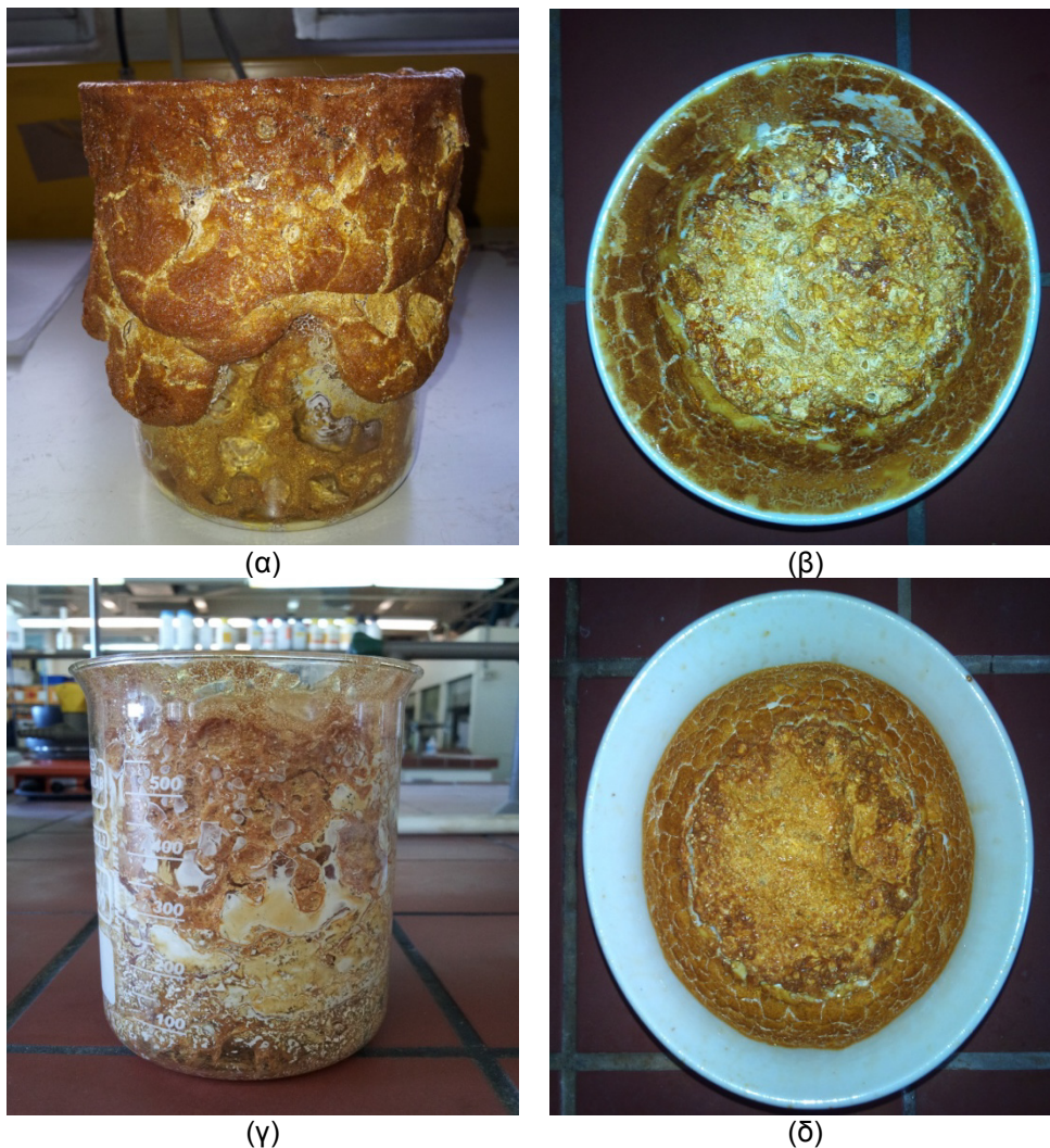
Σχήμα IV.2. Φωτογραφίες των πρόδρομων υλικών των ενώσεων \text{La}_{9.83}\text{Si}_6\text{O}_{26+\delta} (α), \text{La}_{9.33}\text{Sr}_{0.50}\text{Si}_6\text{O}_{26+\delta} (β) \text{La}_{9.33}\text{Sr}_{0.50}\text{Si}_{5.70}\text{Al}_{0.30}\text{O}_{26+\delta} (γ) και \text{La}_{9.33}\text{Sr}_{0.50}\text{Si}_{5.50}\text{Al}_{0.50}\text{O}_{26+\delta} (δ).
