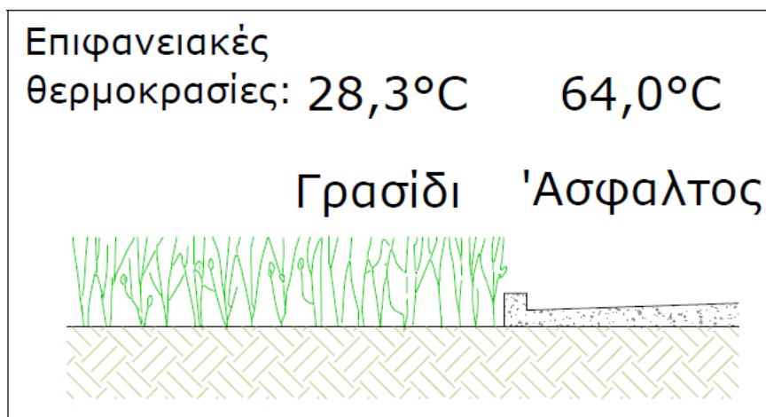
Εικόνα 1.10. Μετρήσεις επιφανειακών θερμοκρασιών σε φυτεμένη επιφάνεια με γρασίδι και σε άσφαλο κατά τη διάρκεια της ημέρας το καλοκαίρι, στο κέντρο της Αθήνας.
