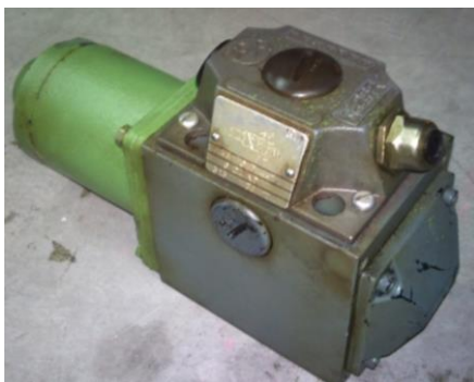
Σχήμα 6.2.1.3 Φωτογραφία και τομή βαλβίδας κατευθύνσεως 4/2-NG10
