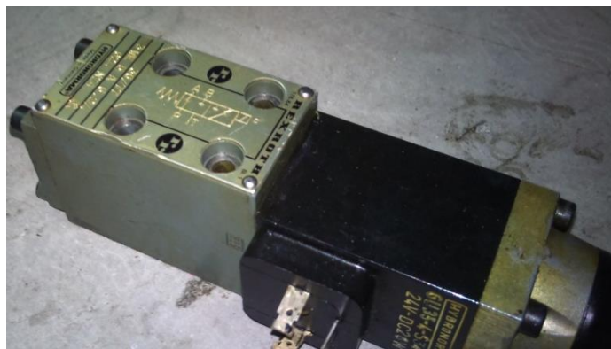
Σχήμα 6.2.1.2 Φωτογραφία βαλβίδας κατευθύνσεως 3/2 NG6
