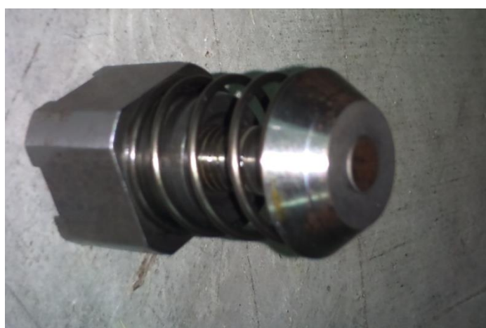
Σχήμα 6.1.5. Τομή βαλβίδας DBD
