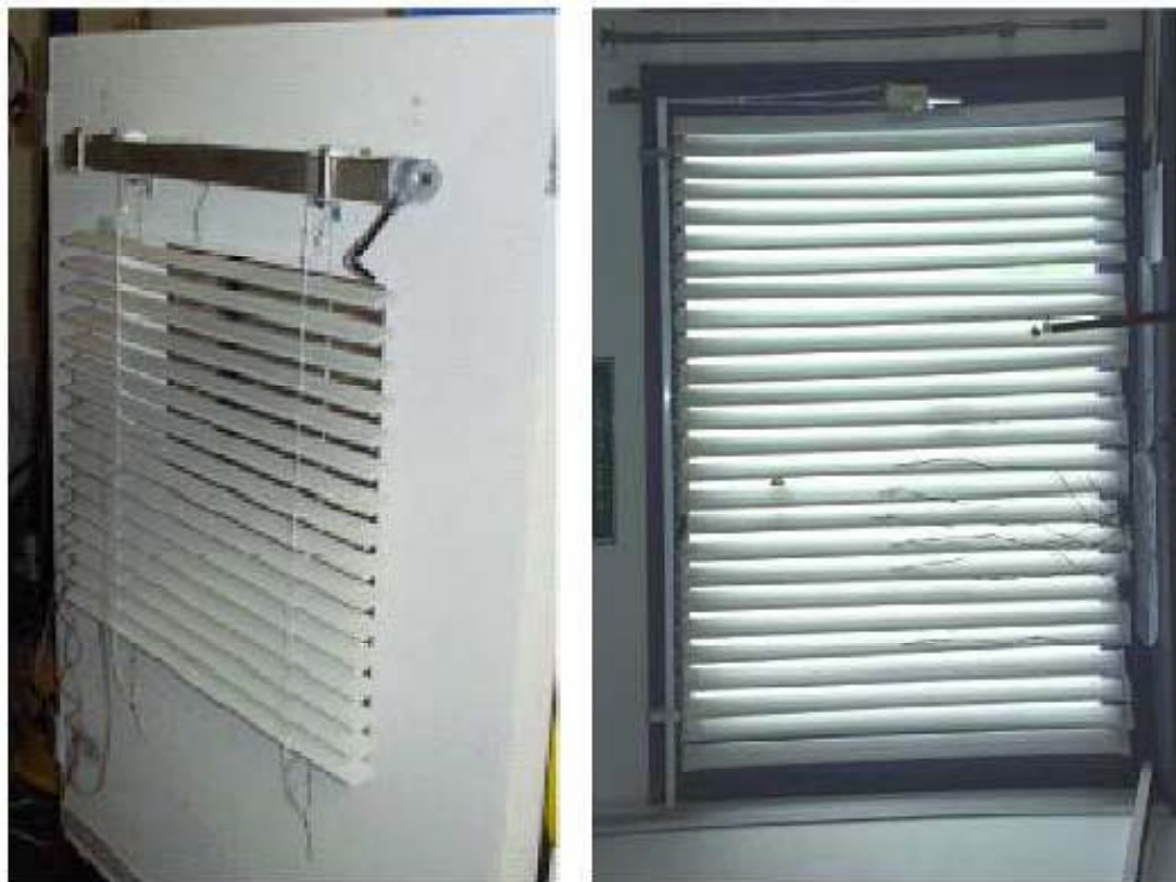
Σχήμα 6.9. Κάθετες και οριζόντιες εσωτερικές γρίλιες παραθύρων με P.C.M.
