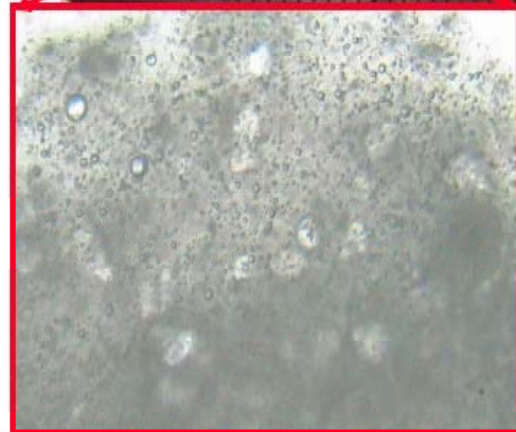
Σχήμα 4.4. Εικόνα της ανομοιογένειας που παρουσιάζουν τα περισσότερα P.C.M.
