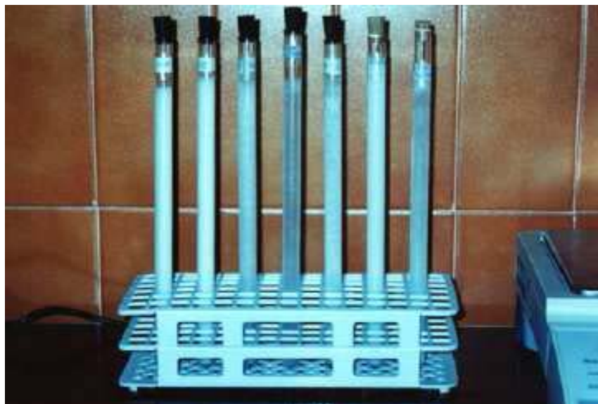
Σχήμα 4.7. Σωλήνες που χρησιμοποιούνται στη μέθοδο T-HISTORY
