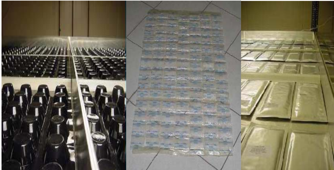
Σχήμα 6.5. Συσκευασίες P.C.M. για κτηριακές εφαρμογές
