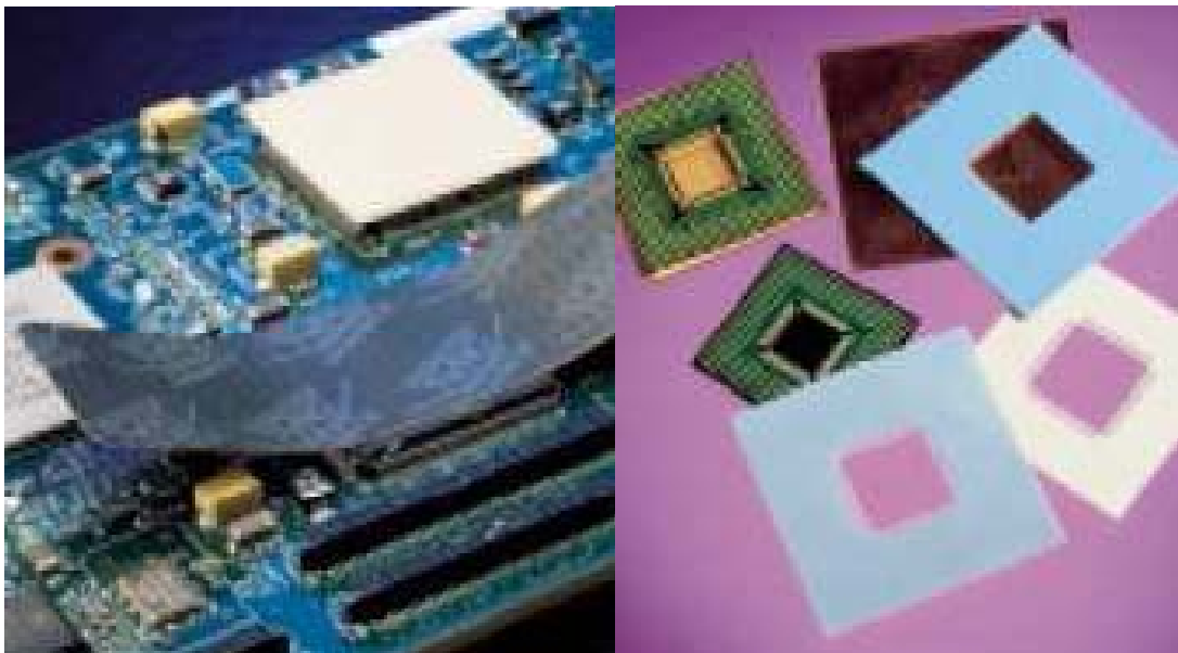
Σχήμα 6.18. Προϊόντα για ψύξη επεξεργαστών ηλεκτρονικών πλακετών
