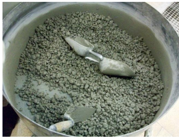
Εικόνα 5.1 Παρασκευή σύνθεσης πορώδους σκυροδέματος
