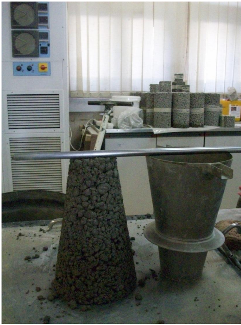
Εικόνα 5.2 Έλεγχος κάθισης νωπού μίγματος
