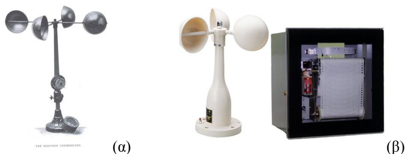
Εικ. 2.11 (α) Κυπελλοφόρο ανεμόμετρο του τύπου που εφευρέθηκε από τον John Thomas Romney Robinson το 1846 (β) σύγχρονο κυπελλοφόρο ανεμόμετρο [Πηγή: http://en.wikipedia.org/wiki/Anemometer ]
