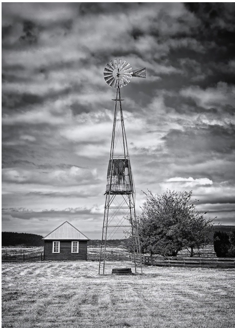
Εικ. 3.4 Ανεμόμυλος με ατσάλινα πτερύγια για άντληση νερού στα μεσοδυτικά των Η.Π.Α [Πηγή: http://wizardofwonders.photoshelter.com ]
