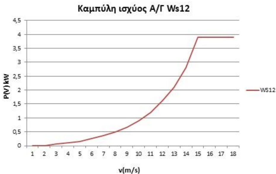
Εικ. 6.47 Καμπύλη ισχύος (power curve) ανεμογεννήτριας Ws12 [Πηγή: WindRose]
