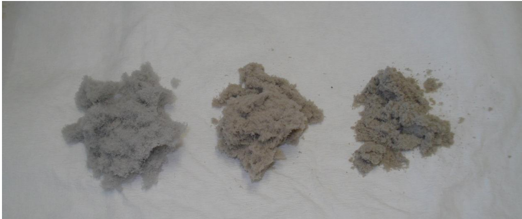
Εικόνα 5.6 Αριστερά η φυσικά κατεργασμένη χαρτόμαζα, στη μέση η χημικά κατεργασμένη χαρτόμαζα με κιτρικό οξύ συγκέντρωσης 1M, και δεξιά η χημικά κατεργασμένη χαρτόμαζα με κιτρικό οξύ συγκέντρωσης 2M
