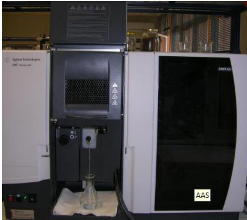
Εικόνα 5.3 Agilent Technologies 200 Series AA
