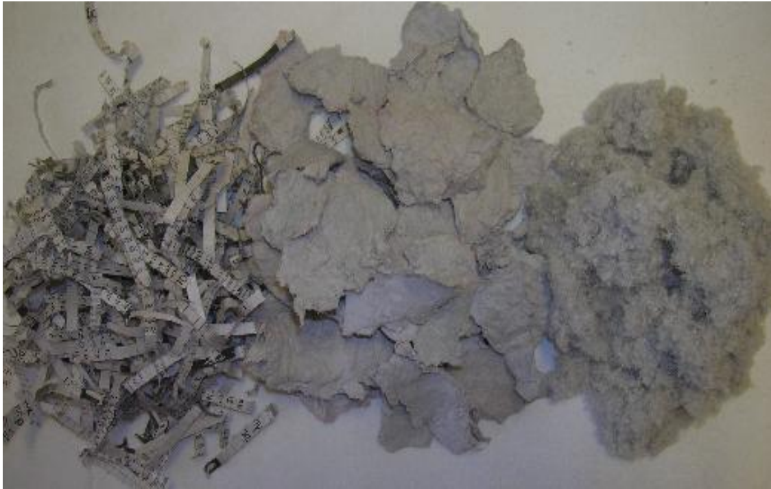
Εικόνα 5.4 Τα τρία στάδια του προσροφητικού μέσου: τεμαχισμός, ξήρανση μετά την πολτοποίηση, χνουδωτή μορφή μετά το άλεσμα.
