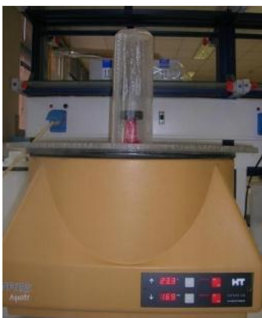
Εικόνα 5.1 Ανακινούμενο υδατόλουτρο εργαστηριακής κλίμακας με συστήματα
