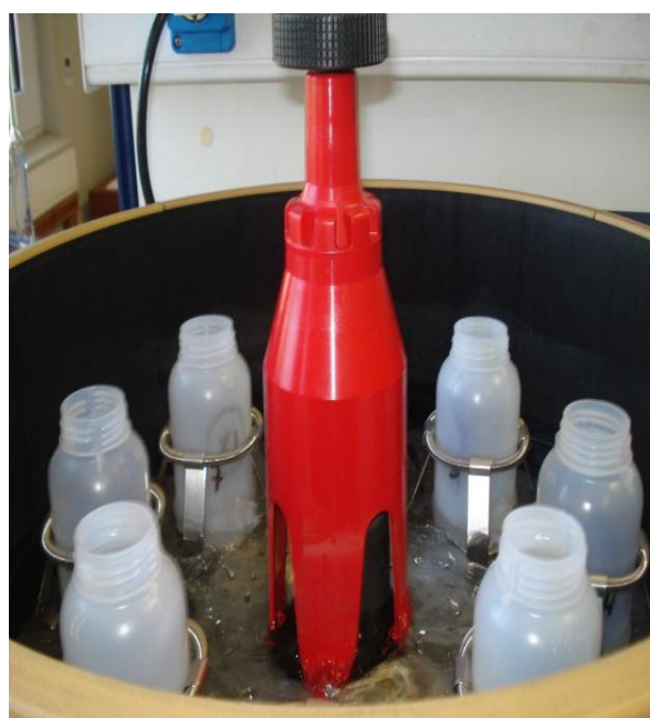
Εικόνα 5.2 Εσωτερικό ανακινούμενου υδατόλουτρου διαλείποντος έργου (batch)
