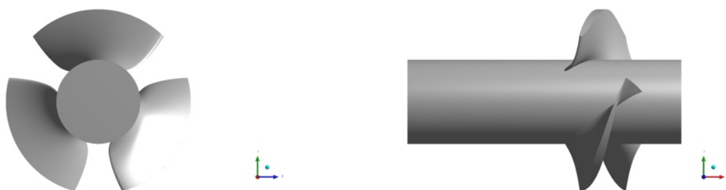
Σχήμα 5.16 : Γεωμετρία βοηθητικής πτερωτής αντλίας με τρία πτερούγια
