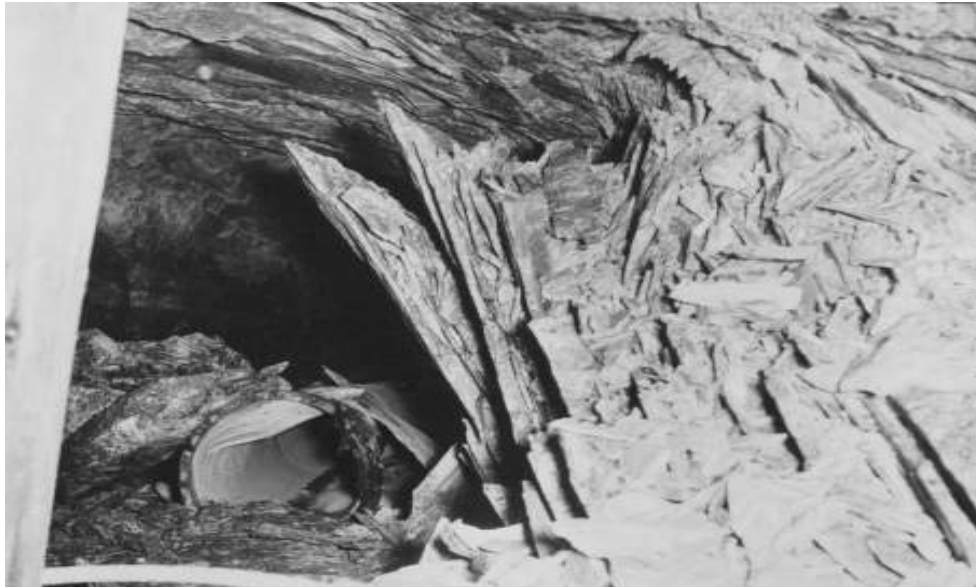
Εικόνα 1.8 : Αποτελέσματα ψαθυρής θραύσης σε βάθος 3000m σε ορυχείο χρυσού στην Ν. Αφρική (Hoek, 2007)
