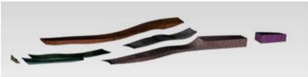
Εικόνα 2.4: Τρισδιάστατο διακριτοποιημένο γεωλογικό μοντέλο με πεπερασμένα στοιχεία, με ξεχωριστά τα γεωλογικά στρώματα. (Σίμου, 2010)
