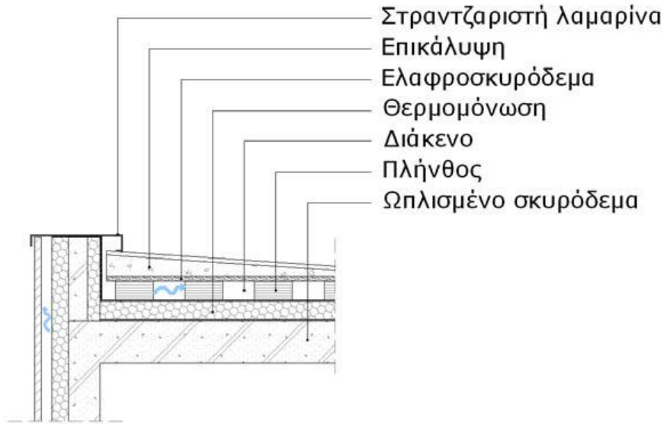
Εικ. 2.34 Τομή σε αεριζόμενο δώμα Πηγή: TOTEE 20702-5/2010
