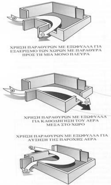
Εικ. 2.35 Η διάταξη των ανοιγμάτων και η ροή του αέρα στο εσωτερικό του κτηρίου Πηγή: TOTEE 20702-5/2010
