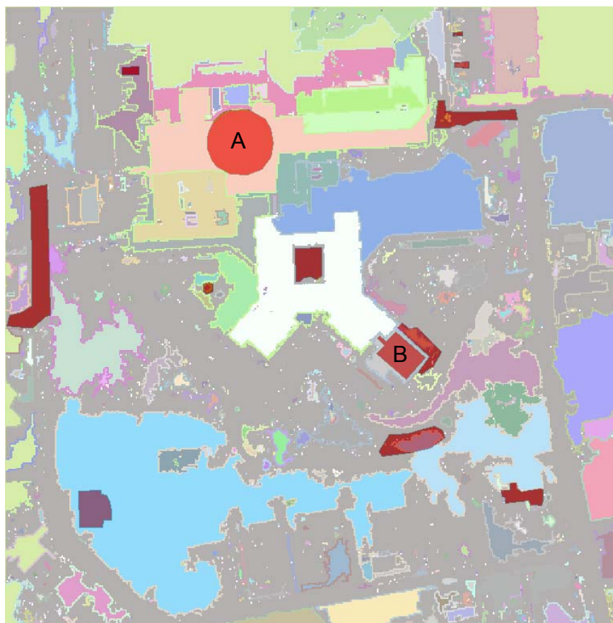
Εικόνα 3.69 - Αντικείμενα αναφοράς σε επικάλυψη με το αποτέλεσμα της κατάτμησης, στην εικόνα περιοχής της Γερμανίας, με δείκτη ED2 (Region Growing - Min Fitness / Min Raw = 42,1 / 49,2)
