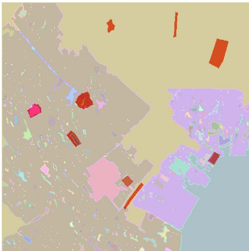
Εικόνα 3.59 - Αντικείμενα αναφοράς σε επικάλυψη με το αποτέλεσμα της κατάτμησης, στην εικόνα του Αγ. Στεφάνου, με δείκτη ED1 (Region Growing - Min Fitness / Min Raw = 0,43 / 0,70)
