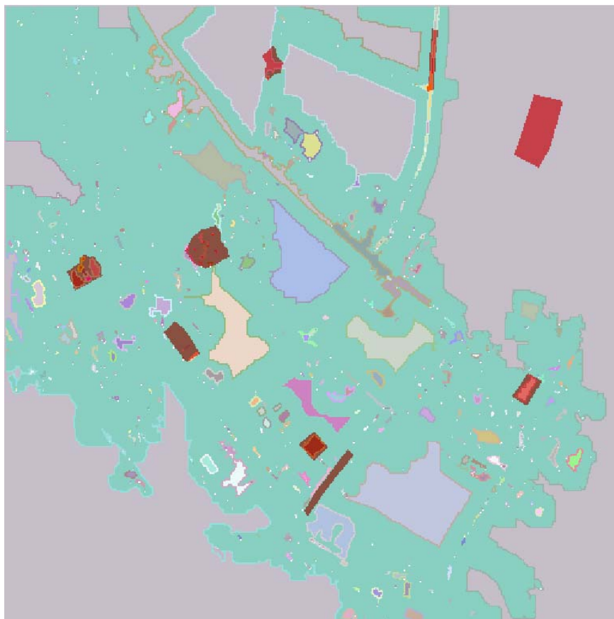
Εικόνα 3.64 - Αντικείμενα αναφοράς σε επικάλυψη με το αποτέλεσμα της κατάτμησης, στην εικόνα του Αγ. Στεφάνου, με δείκτη (ED1+ED2)/2 (Region Growing - Min Fitness / Min Raw = 67 / 51)
