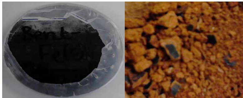
Σχήμα 5.15. Φωτογραφία δείγματος τροποποιημένου με νανοσωματίδια σιδήρου μηδενικού σθένους Fe(0), α) μπεντονίτη, έπειτα από μία εβδομάδα παρασκευής και β) ζεόλιθου, έπειτα από 24 h παρασκευής
