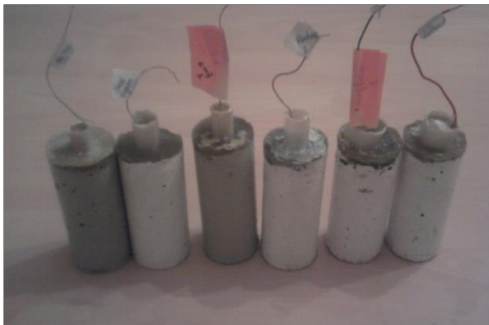
Εικόνα 8: Τελική όψη αντιπροσωπευτικών δοκιμίων μετά την οχτάμηνη μεταχείριση στο διαβρωτικό περιβάλλον
