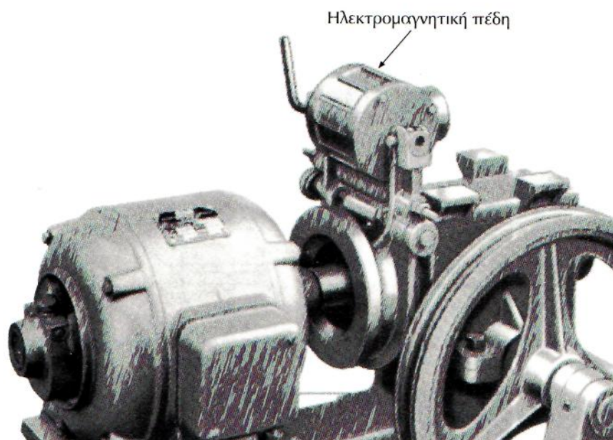
Σχήμα 3.9. Μορφή ηλεκτρομαγνητικής πέδης ανυψωτικού μηχανισμού ανελκυστήρα.
