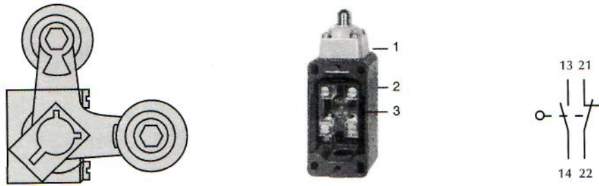
Σχήμα 5.12. (α) Μορφή βραχιόνων διακοπών ορόφου, (β) Κυρίως σώμα διακόπτη (1), Μετάδοση κίνησης (ωστήριο) (2) χυτό περίβλημα (3) επαφές, (γ) Ηλεκτρολογική σχεδίαση επαφών και συμβολισμός τους.
