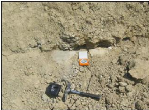
Εικόνα 2.10: Επιφάνεια ολίσθησης στο δυτικό μέτωπο
