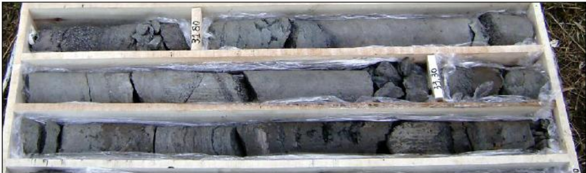
Εικόνα 2.6: Κυανές μάργες με παρεμβολές ψαμμίτη και τύφρης
