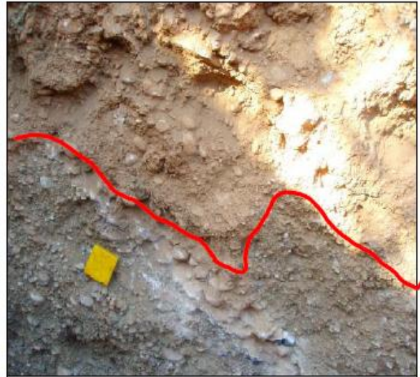
Εικόνα 2.9: Επαφή κορηματικών υλικών με το υπόβαθρο
