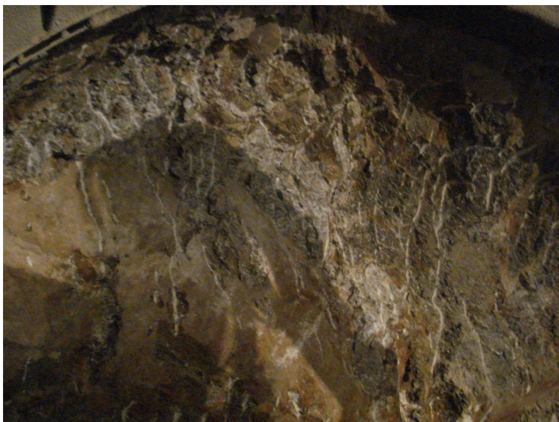
Εικ.13: Εμφάνιση ρηξιγενούς ζώνης μέσα σε κρητιδικούς ασβεστόλιθους
