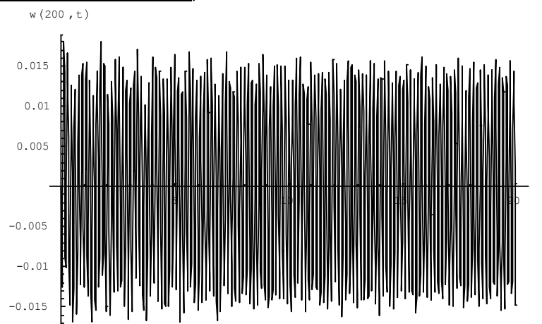
Σχήμα 3.8 Παραμορφώσεις κατασκευής με σύστημα απόσβεσης ολισθαίνουσας μάζας -T.M.D ( M_\alpha = 400\text{tn.} ) στη θέση x_\alpha = 200\text{m.} με K_\alpha = 100 , C_\alpha = 10 .
