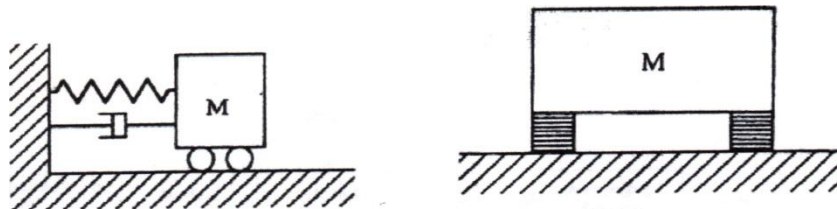
Εικόνα 1.14 Ελευθέρως ολισθαίνουσα μάζα συνδεδεμένη με ελατήριο και αποσβέστη – Μάζα συνδεδεμένη με ελαστομεταλλικά εφέδρανα.
