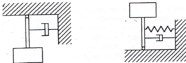
Εικόνα 1.12 Εκκρεμές συνδεδεμένο μέσω αποσβεστήρα με το δόμημα – Ανεστραμμένο εκκρεμές συνδεδεμένο με το δόμημα μέσω ελατηρίου και αποσβεστήρα.
