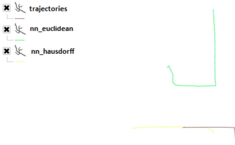
Σχήμα 5.4: Παράδειγμα κοντινότερου γείτονα με ευκλείδεια και hausdorff απόσταση τροχιάς. Χρησιμοποιήθηκε χρονικό παράθυρο T = [2008-02-03 19:40:36.604, 2008-02-03 19:55:36.604] και τροχιά ερώτησης TRquery με id 8838 από το T-Drive trajectory dataset.
