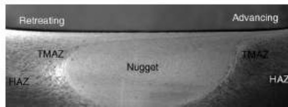
Σχήμα 4-4 Διάφορες ζώνες μικροδομής σε FSP κατεργασμένο κράμα Al7075-T651 (σπειροειδής πείρος, 400rpm, 51 mm/min)
