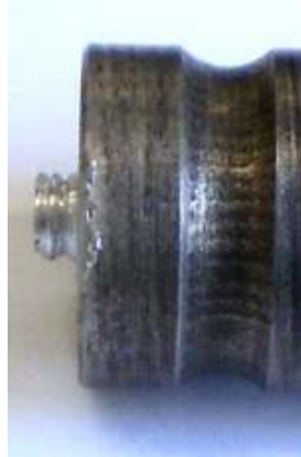
Σχήμα 6-4 Εικόνα του περιαιχενίου και του του κυλινδρικού πείρου με σπείρωμα.
