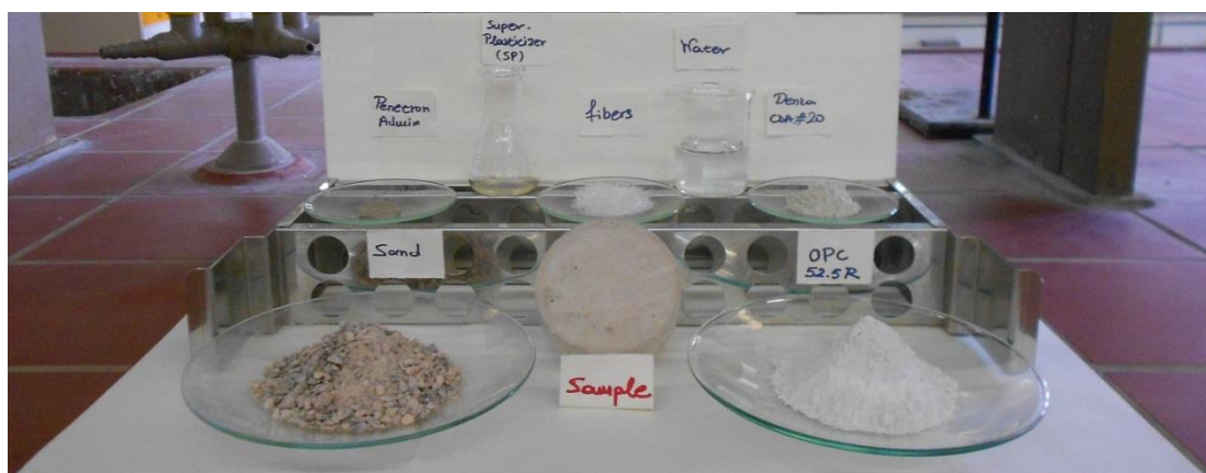
Σχήμα 5.1 Πρώτες ύλες για την Παρασκευή των δοκιμίων (πραγματικές ποσότητες για δοκίμιο M6)
