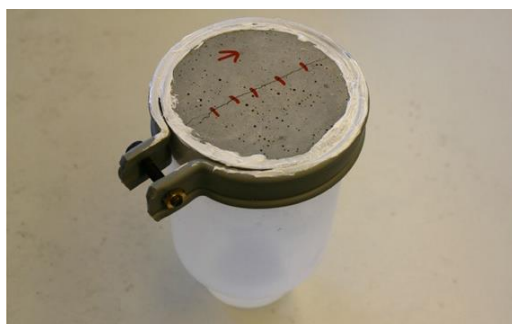
(α) Δείγμα για την δοκιμή διέλευσης του νερού
