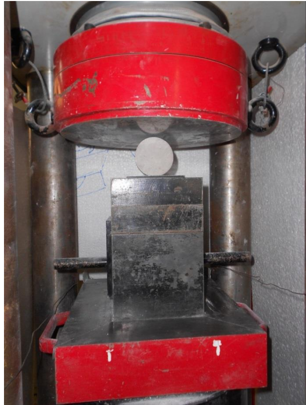
Σχήμα 5.9 Δοκίμιο σε διαδικασία τεχνικής θλίψης με δοκιμή σε διάρρηξη
