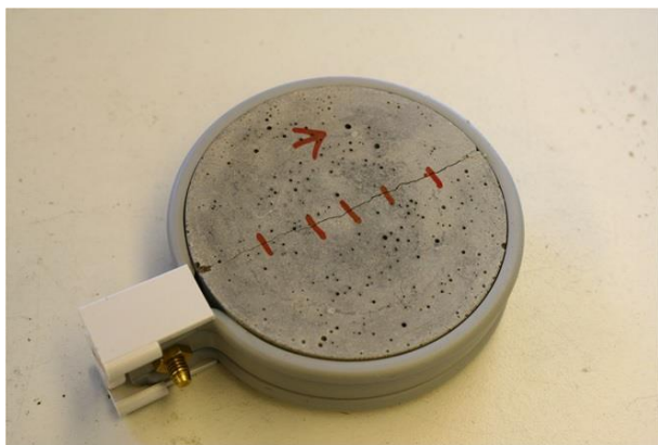
Σχήμα 3.3 Δοκίμιο σε σφικτήρα PVC. Σημεία μέτρησης ανά 10 mm
