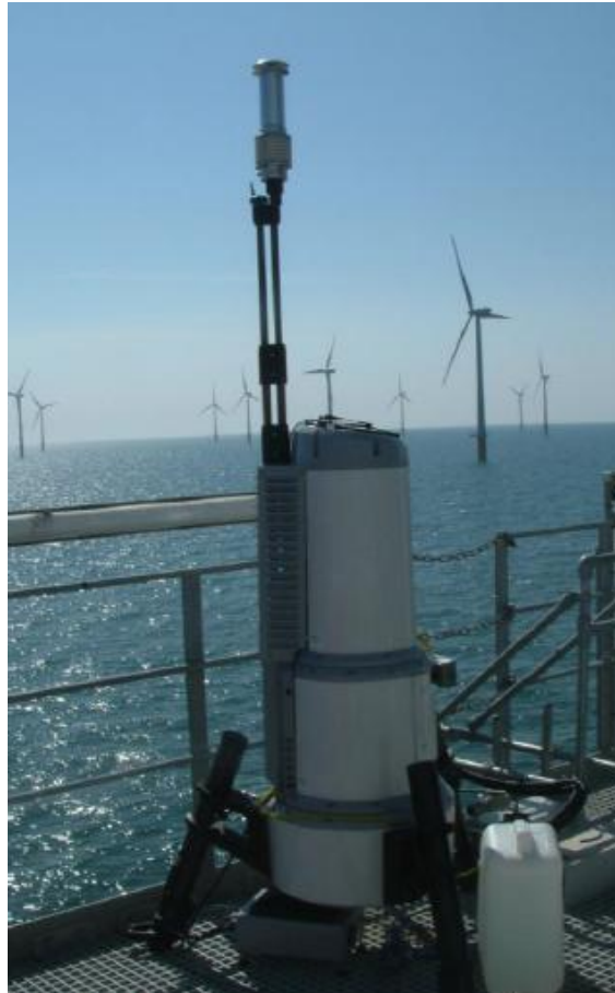
Εικόνα 2. 6. Εγκατεστημένο LiDAR (μοντέλο ZephIR ) σε υποσταθμό πλατφόρμας στο πρώτο παράκτιο αιολικό πάρκο της Σκωτίας, το Robin Rigg (180MW) στο Solway Firth .
