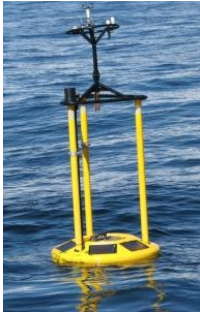
Εικόνα 2. 1. Μετρητικός σταθμός τύπου Sea-Watch του συστήματος POSEIDON .
