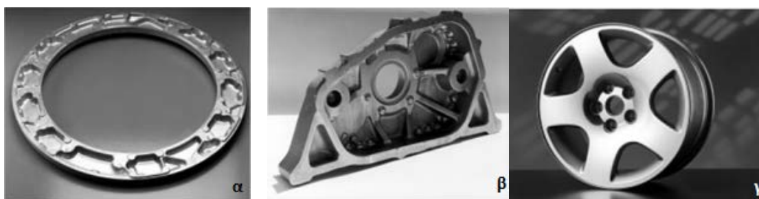
Εικόνα 4 Χρήσεις του κράματος ZK30: α) Σφυρήλατο εξάρτημα ελικοπτέρου (ZK30-T6, \varnothing 700mm)
