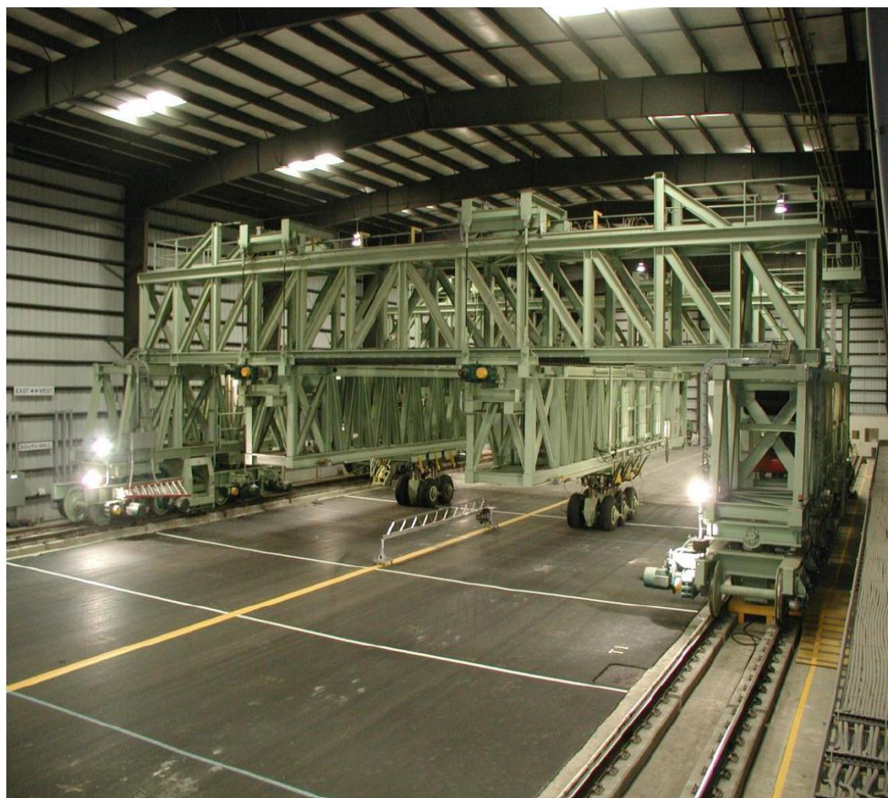
Εικόνα 5.2 Όχημα προσομοίωσης φορέων αεροσκαφών
