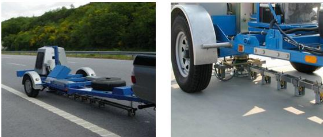
Εικόνα 4.10 Συσκευή παραμορφωσιμέτρου πίπτοντος βάρους (FWD)
