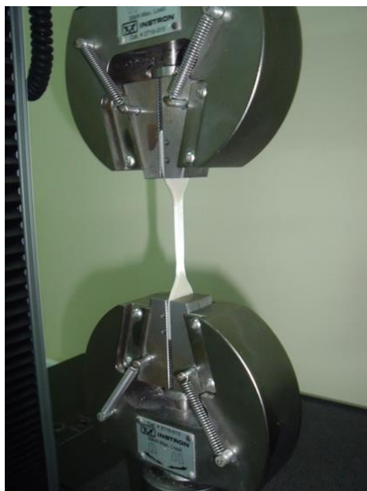
Σχήμα 3.20: Πραγματοποίηση πειραμάτων εφελκυσμού με τη συγκεκριμένη συσκευή Instron
