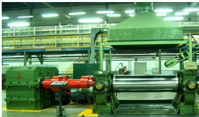
Εικόνα 2.4: Απεικόνιση ενός κυλινδρόμυλου ανάμιξης
