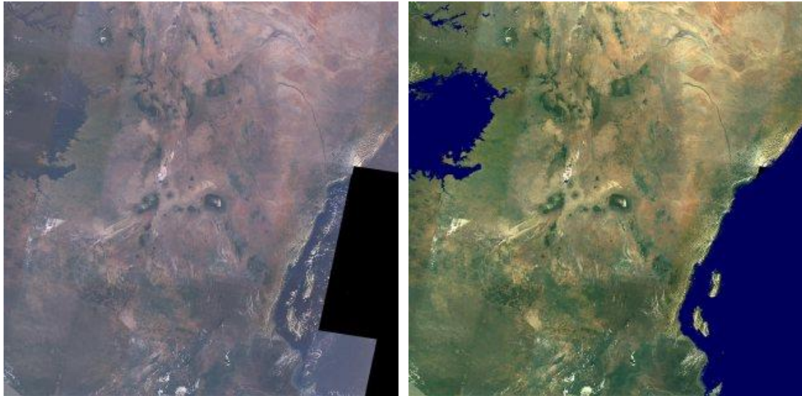
Εικόνα 2.3. Εικόνα LANDSAT πριν και μετά την γεωμετρική και ραδιομετρική διόρθωση (LANDSAT Web, Image Archive).
