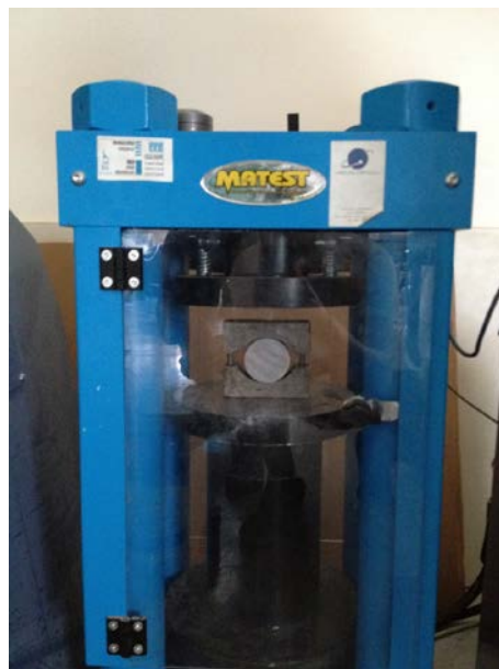
Εικόνα 52: Δοκιμή εφελκυστικής αντοχής (Brazilian Test)
