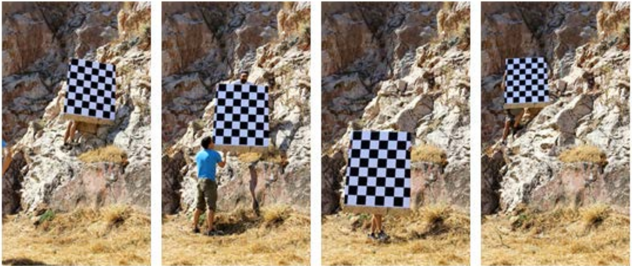
Εικόνα 34: Εικόνα βαθμονόμησης από αριστερή φωτομηχανή
