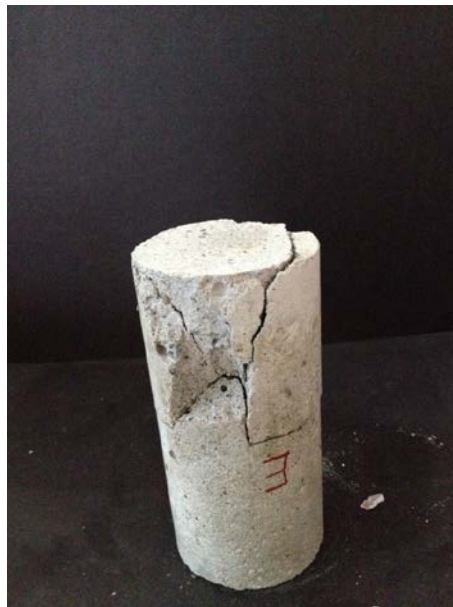
Εικόνα 51: Αστοχία ενέματος σε δοκιμή μονοαξονικής θλίψης
