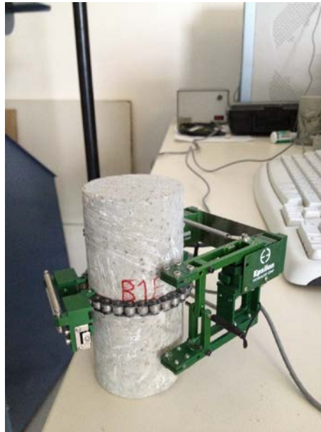
Εικόνα 50: Δοκίμιο με τα μηχανισιόμετρα κατά τη δοκιμή μονοαξονικής θλίψης
