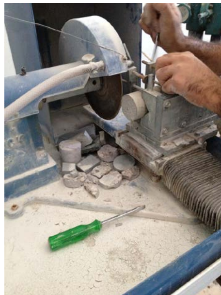
Εικόνα 49: Κοπή και λείανση άκρων κυλινδρικών βραχωδών δοκιμίων
