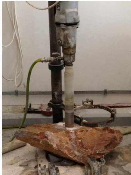
Εικόνα 48: Διάτρηση δοκιμίων βράχου
