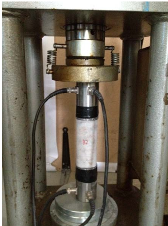
Εικόνα 54: Εργαστηριακός εξοπλισμός για τη μέτρηση διάδοσης των υπερήχων
