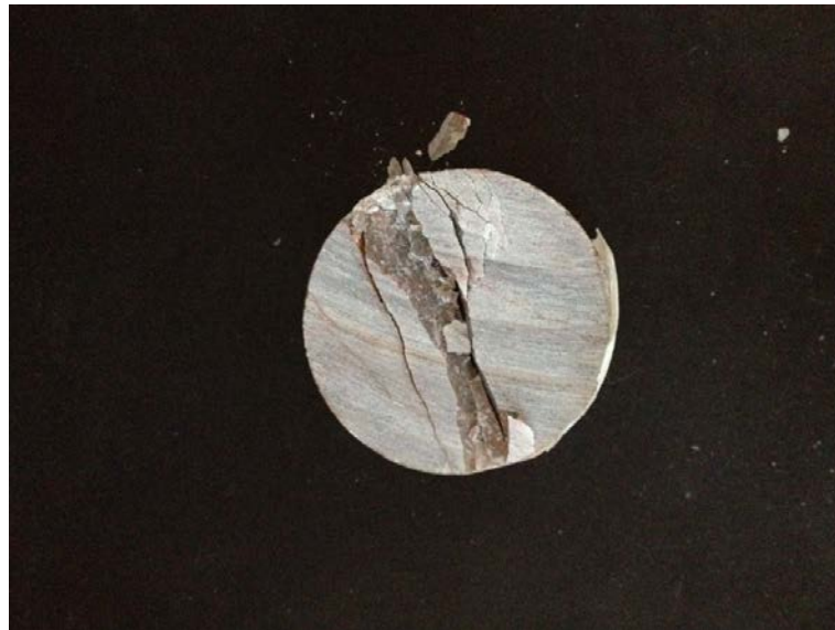
Εικόνα 53: Δοκίμιο ενέματος μετά την αστοχία του σε εφελκυσμό
