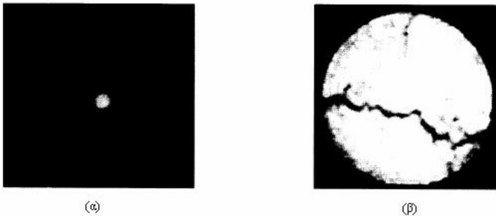
Εικόνα 1.2. Μηχανογραφημένη τομογραφική απεικόνιση ενός (α) κυλίνδρου σκυροδέματος με ράβδο οπλισμού στο κέντρο, (β) απλού κυλίνδρου σκυροδέματος φορτισμένο σε αστοχία
