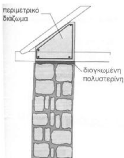
Εικόνα 7: Κατασκευή οριζόντιου διαζώματος υπό στέγη με μεγάλη κλίση
