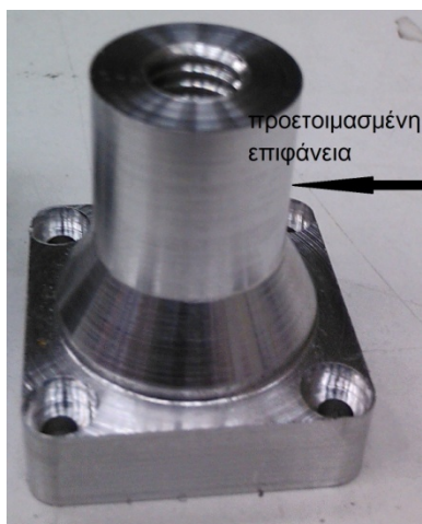
Σχήμα 3-7. Προετοιμασία του προσαρμογέα.
