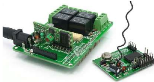
Εικόνα 33: Πλακέτα Relay Shield με ενσωματωμένο 315M RF για ασύρματη επικοινωνία.
