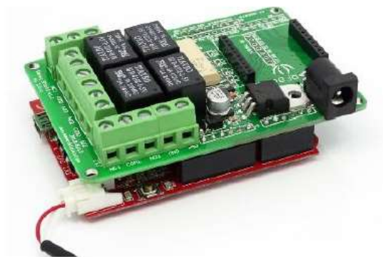
Εικόνα 32: Πλακέτα Relay Shield ενσωματωμένη σε πλακέτα Arduino.
