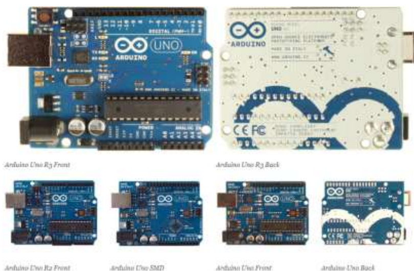
Εικόνα 28: Όψεις της πλακέτας Arduino Uno.
