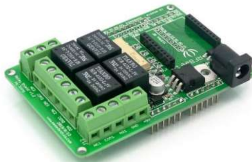
Εικόνα 31: Πλακέτα Relay Shield.
