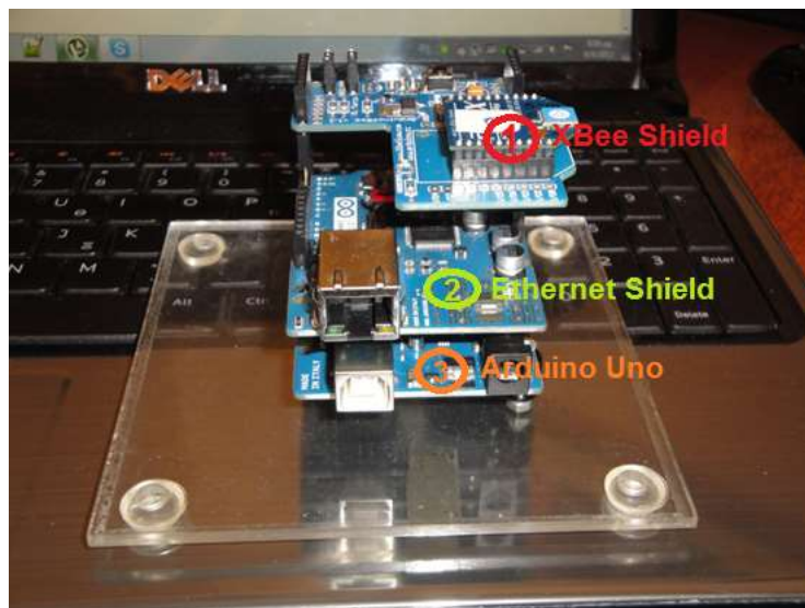
Εικόνα 49: Υλοποίηση Κόμβου Σταθμού Βάσης.
