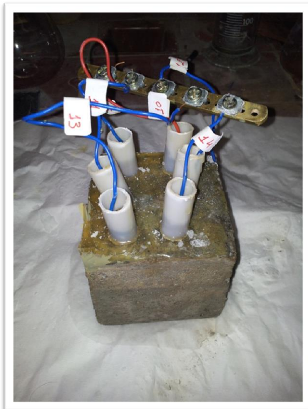
Φωτογραφία 3. Δοκίμιο 3 με σπλισμούς από 9-14 με φύλλο Zn στους δύο πρώτους
