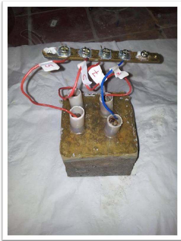
Φωτογραφία 2. Δοκίμιο 2 με σπλισμούς από 5-8 με φύλλο Zn στους δύο πρώτους
