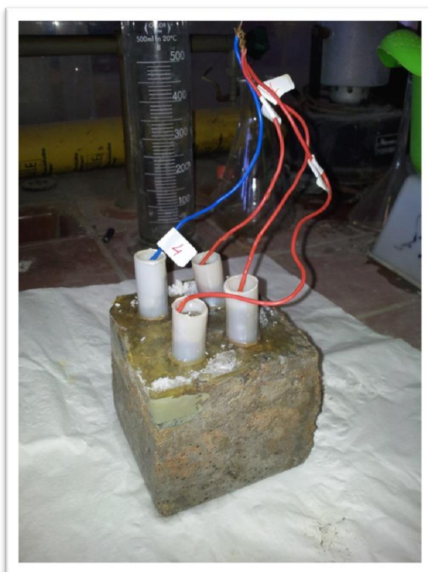
Φωτογραφία 1. Δοκίμιο 1 με οπλισμούς από 1-4 που λειτουργεί ως «μάρτυρας»
