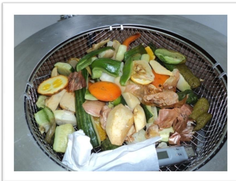
Εικόνα 63: Ο καταγραφέας στο εσωτερικό της συσκευής ξήρανσης μαζί με οργανικά απορρίμματα.
