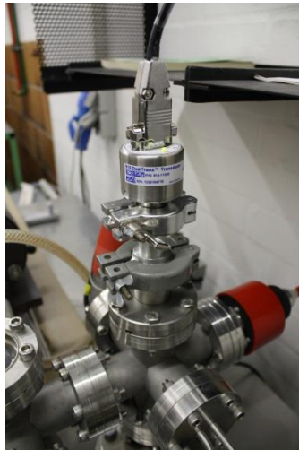
Εικόνα 33: Ο αισθητήρας πίεσης, συνδεδεμένος με ένωση KF πάνω στον οπίσθιο σταυρό
