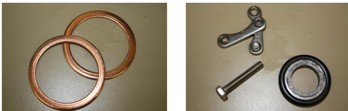
Εικόνα 35: Αριστερά: χάλκινοι δακτύλιοι που χρησιμοποιούνται ως μόνωση σε ενώσεις τύπου CF. Δεξιά: βίδες και παξιμάδια που χρησιμοποιούνται για την σύσφιξη των δακτυλίων τύπου CF και δαχτυλίδι από ανοξείδωτο χάλυβα και Viton® για την στεγανοποίηση των ενώσεων KF.
