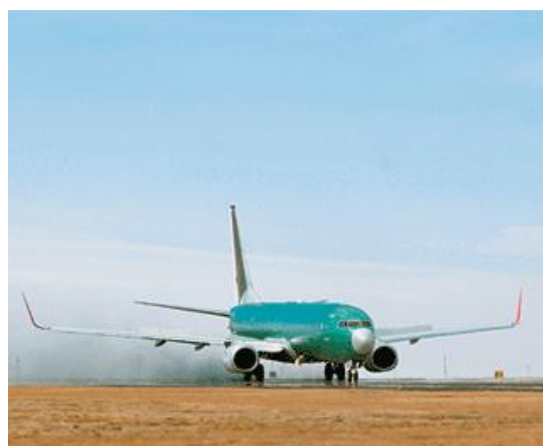
Εικόνα 10: Ένα νέας γενιάς 737-900 μακράς εμβέλειας πραγματοποιεί δοκιμή ακύρωσης απογείωσης για να πιστοποιήσει ότι τα φρένα carbon μπορούν να σταματήσουν με ασφάλεια ένα αεροσκάφος πλήρους φορτίου σε αντίστοιχη περίπτωση [φωτογραφία της Boeing]
