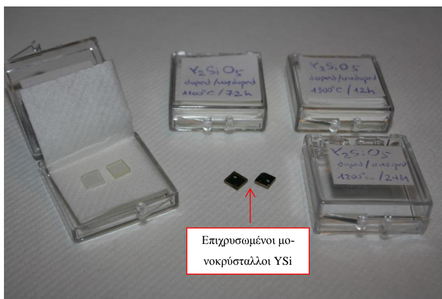
Εικόνα 38: Επιχρυσωμένα και μη επιχρυσωμένα δοκίμια (μονοκρύσταλλοι YSi). Μάλιστα στα επιχρυσωμένα της φωτογραφίας έχει γίνει μέτρηση με SIMS και διακρίνονται οι κρατήρες.
