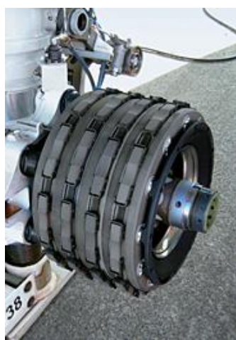
Εικόνα 9: Φρένα Carbon επιβατικού αεροσκάφους
