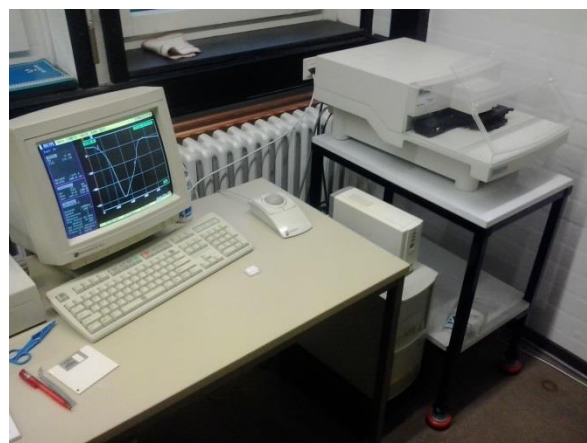
Εικόνα 59: Προφιλόμετρο της εταιρίας Tencor στο ινστιτούτο Μεταλλουργίας του Πολυτεχνείου του Clausthal και ο ηλεκτρονικός υπολογιστής με τον οποίο γίνεται ο χειρισμός του.
