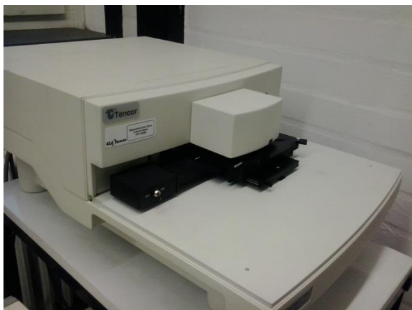
Εικόνα 59: Προφιλόμετρο της εταιρίας Tencor στο ινστιτούτο Μεταλλουργίας του Πολυτεχνείου του Clausthal και ο ηλεκτρονικός υπολογιστής με τον οποίο γίνεται ο χειρισμός του.
