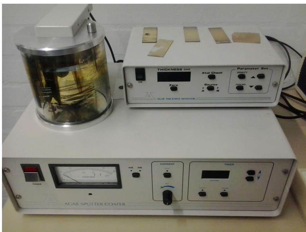
Εικόνα 39: Συσκευή sputtering της Agar Sputter. Είναι εμφανές το στρώμα χρυσού που έχει δημιουργηθεί από το πλάσμα στα διάφανα τοιχώματα του θαλάμου.
