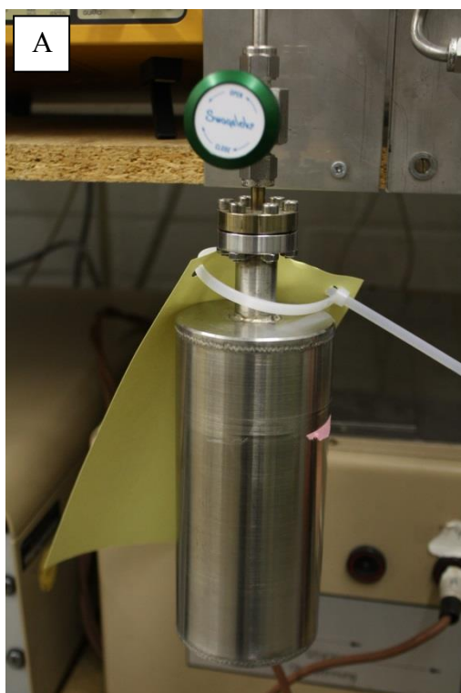
Εικόνα 37: A) Η φιάλη φύλαξης του ιχνηθέτη ( ^{18}\text{O}_2 ) και B) το δοχείο όπου φυλάσσεται στο εργαστήριο το απαραίτητο υγρό άζωτο
