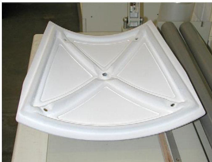
Εικόνα 23: Προστατευτικό πάνελ από το ρύγχος διαστημικού λεωφορείου, από σύνθετο υλικό C/C – SiC επικαλυμμένο με μολίτη (οπίσθια όψη)
