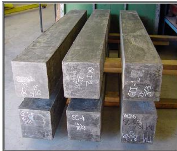
Εικόνα 1.23: Κολώνες από γεωπολυμερή μετά την απομάκρυνσή τους από τα εκμαγεία [29]
