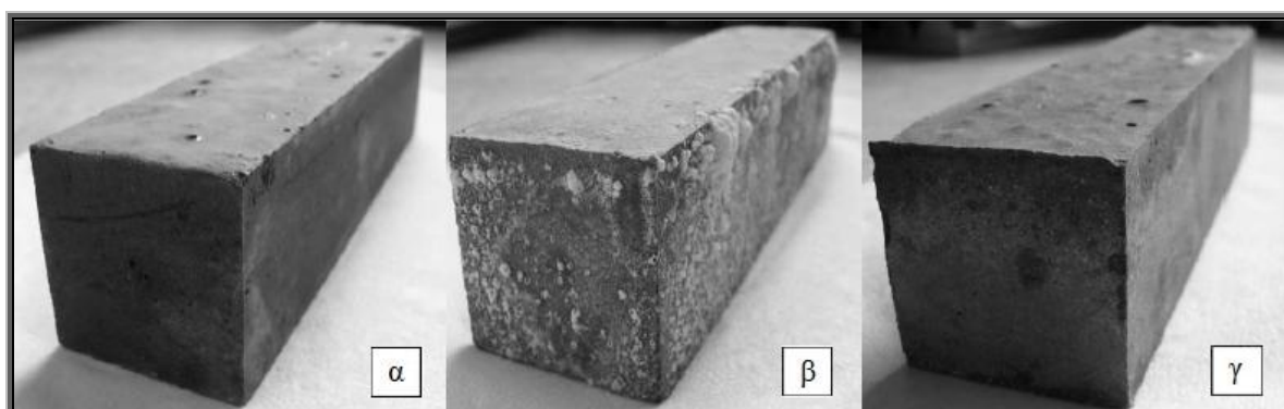
Εικόνα 1.18: Κονιάματα γεωπολυμερών μετά από 600 ημέρες έκθεσής τους σε διαλύματα (α) NaCl (β) NaSO 4 και (γ) MgSO 4
