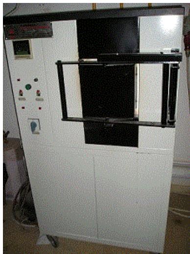
Εικόνα 6.4: Φούρνος υψηλών θερμοκρασιών
