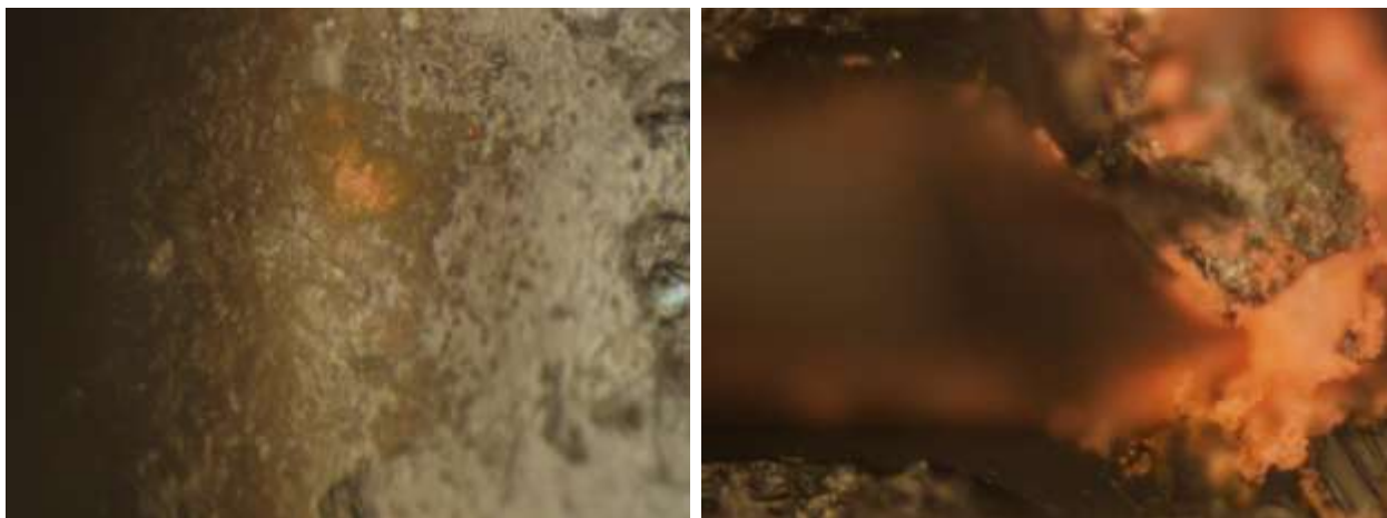
Εικόνα 4.2.6 (α) Εικόνα της ταινίας ελασματοποίησης και (β) εικόνα της εισόδου του μικροκαναλιού από το μικροσκόπιο με σκοτεινό πεδίο (dark field). Είναι εμφανής η συγκέντρωση σωματιδίων και στις δύο περιπτώσεις.
