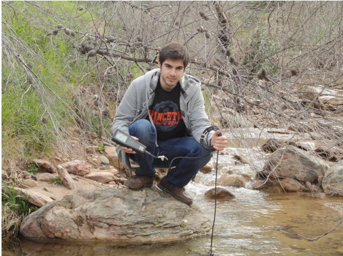
Σχήμα 3.2: Μέτρηση φυσικοχημικών παραμέτρων με το πολύμετρο YSI Professional Plus
