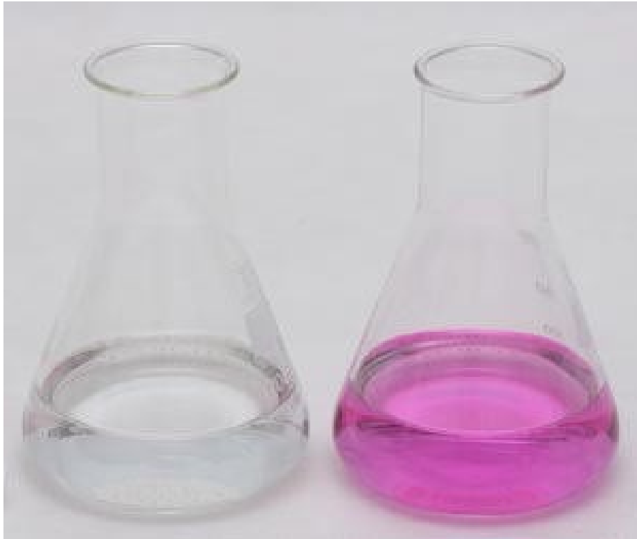
Σχήμα 3.6: Αποχρωματισμός δείγματος με τιτλοδότηση θειικού οξέος.
