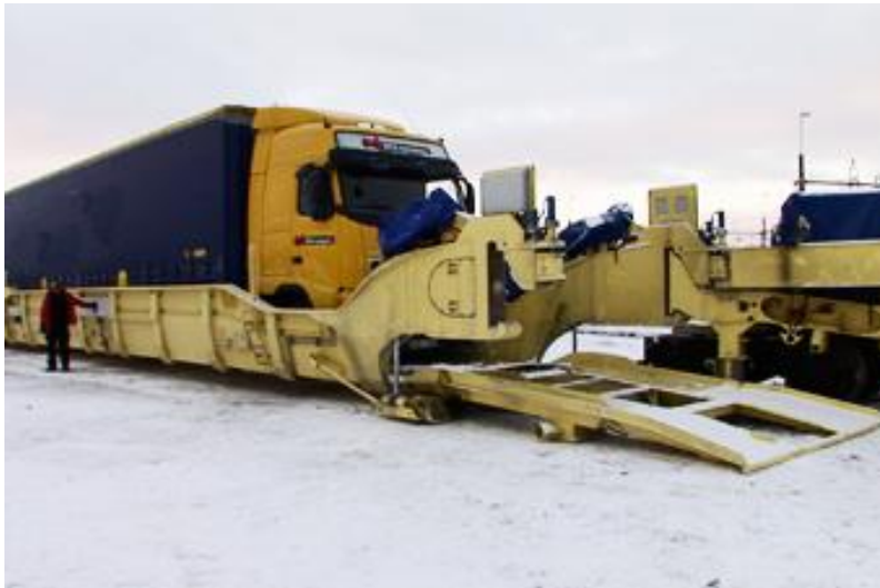
Εικόνα 2.30: Το σύστημα Flexiwaggon (Πηγή www.flexiwaggon.se )
