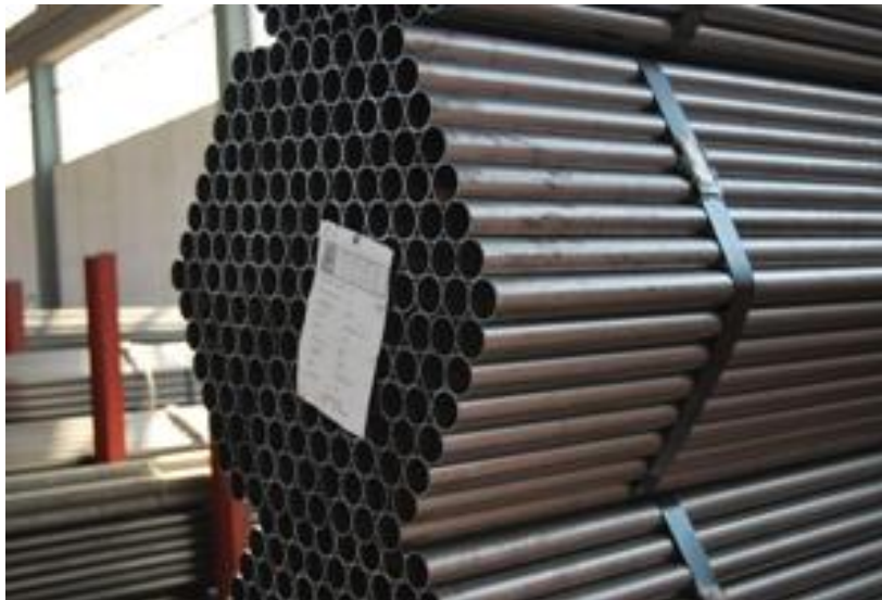
Εικόνα 2.1 Μαύροι χαλυβδοσωλήνες ύδρευσης
