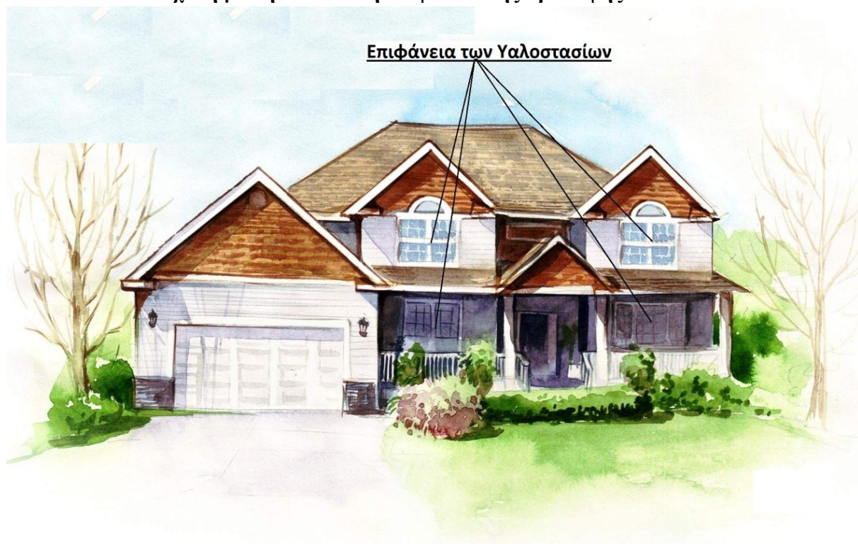
Εικόνα 4.22. Τρόπος εκτίμησης ποσοστού επιφάνειας των υαλοστασίων. Μετρήθηκε από τη φωτογραφία το εμβαδό των υαλοστασίων σε σχέση με το συνολικό εμβαδό της πρόσοψης.[6]
