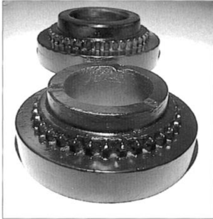
Σχήμα 3.3: Γρανάζια με κενή την περιοχή οδόντωσης- νέα τεχνολογία
